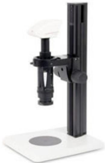
Стереомикроскоп Z6 APO предназначен для высококачественного документирования объектов при относительно небольшом увеличении. Микроскоп имеет встроенную регулируемую ирисовую диафрагму для ручной настройки глубины резкости, привод трансфокатора имеет несколько фиксированных промежуточных положений для обеспечения повторяемости результатов. Оптическая система Z6 APO имеет апохроматическую коррекцию,
