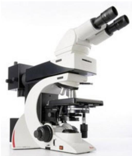
Микроскоп Leica DM2500 имеет мощный 100-ваттный галогенный осветитель, расположенный во внешнем ламповом «домике». Это позволяет комфортно работать с фазовым контрастом и поляризацией даже при использовании низкокачественных, излишне толстых препаратов.
