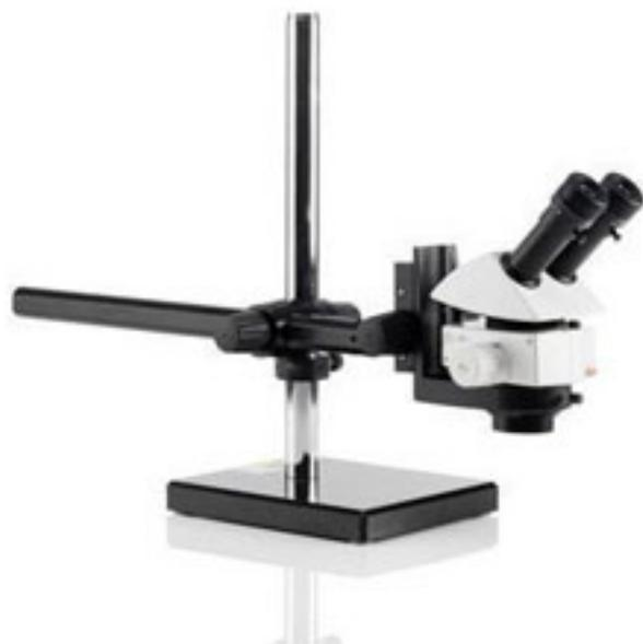
Новый стереомикроскоп Leica M50 имеет пятиступенчатую регулировку увеличения (суммарный диапазон - 6.3:1) и модульную конструкцию. Оптика микроскопа выполнена по схеме Аббе.
