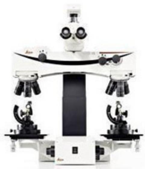
Новый сравнительный микроскоп Leica FS M – это модульная система для проведения баллистических и трасологических исследований. Это комбинация высоконадежных механических приводов с ручным управлением и выдающихся оптико-механических характеристик прибора.
