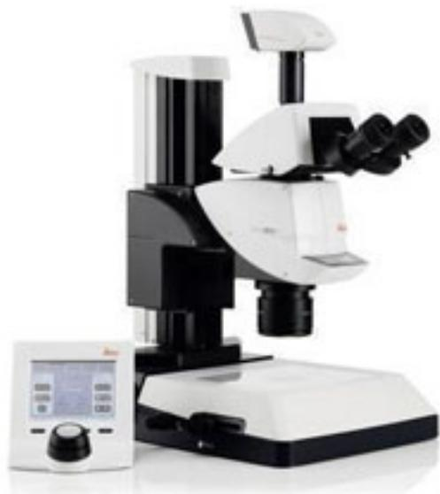
M205 A – это исследовательский моторизованный стереомикроскоп с уникальной системой стереоканалов Fusion Optics, имеет полностью кодированную систему, новую массивную фокусирующую колонку для уменьшения вибрации, максимальной апертуру, апохроматическую зум систему 20,5:1 с плоским полем зрения и эргономическим тубусом.
