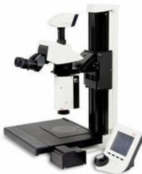
Для этих приборов предлагается широкий набор объективов с повышенным рабочим расстоянием или разрешением, а также модификация привода фокусировки, обеспечивающая непревзойденную точность в 1 мкм.
