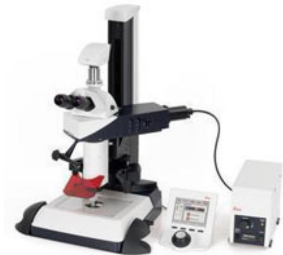
Leica MacroFluo, совмещенная с системами увеличения стереомикроскопов Leica APO Z6 (zoom 6.0:1) или Leica APO Z16 (zoom 16.0:1), позволяет сочетать большое поле зрения и документирование без параллакса при работе с большими расстояниями.
