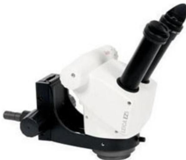
В базовой комплектации микроскоп имеет увеличение 10-50x и рабочее расстояние в 100 мм. Возможна установка дополнительных объективов 0.5x и 0.63x для расширения поля зрения и рабочего расстояния, а также более мощных окуляров 16x и 20x – для более сильного увеличения.
